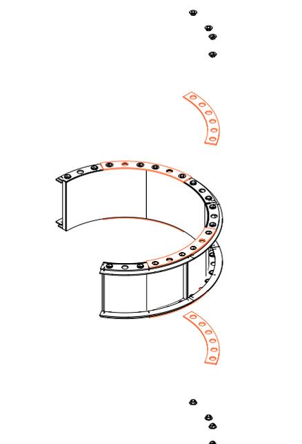
4. 連結したモジュールふたつを、更に同様の方法で連結します。最初の連結モジュールと同様に、木のパネルとビスを使って4カ所とめます。ひっくりかえして、反対側も木のパネルとビスでとめます。
